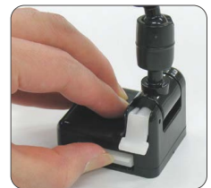
マグネット脱着レバーで簡単に外せます。
