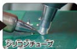
柔軟な耐熱性シリコンが基板に密着し、吸引力がアップ。
